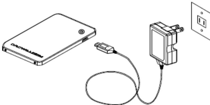
1. 本体の外部接続端子に、ACアダプタの microUSB プラグを差し込みます。
